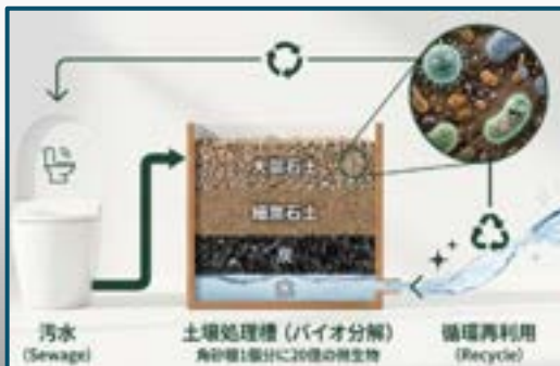
水土浄化システム
